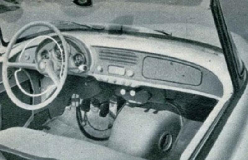
In der Mitte des Armaturenbrettes ist Platz für einen Lautsprecher. Das Bedienteil eines Bordradio muß man allerdings anderweitig unterbringen. Unter der Lautsprecherabblendung befinden sich links der Lichtschalter und rechts vom Aschenbecher der Regelwiderstand für die Armaturenbekleuchtung. Darunter die Zugknöpfe für Gebläse, Scheibenwischer usw., in der Mitte der Blinkerschalter.
