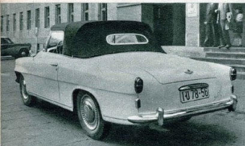
Das Klappverdeck wird, wie im Bild sichtbar, durch zwei Spiegel abgestützt und vorn am Rahmen der Windschutzscheibe mit zwei Schnellverschlüssen gehalten.
